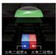
每个像素都配置了2个独立的光电二极管，兼顾对焦和成像的全新单个像素结构。
